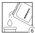
Шаг 6 - Залить теплоноситель и добавить протектор
