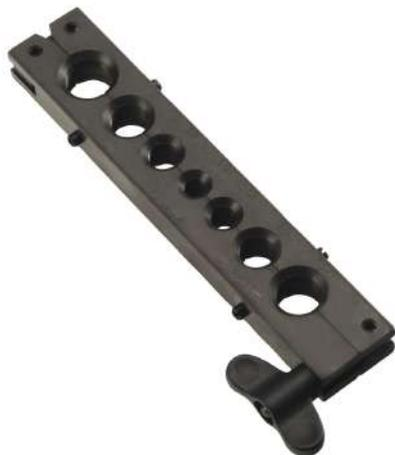
Отверстия в пресс-форме имеют фаску 90° с одной стороны для формирования скошенных фланцев при помощи поворотного штифта. Другую сторону можно использовать для упрочнения скошенных фланцев.
